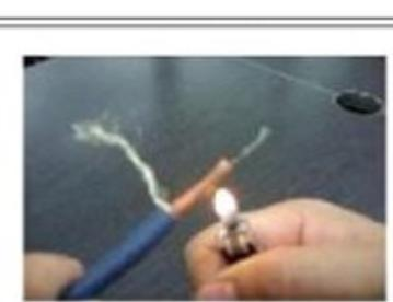
Кабель других производителей покрыт одним слоем термостойкого ПВХ, поэтому при испытании на сжигание, нагревательный провод сгорает. Нагревательный провод кабеля производства компании «DAEWOO ENERTEC» защищен от возгорания покрытием из силиконовой резины. Безопасность во время пожара.
